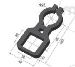
Крепежный хомут KS для монтажа на трубе
